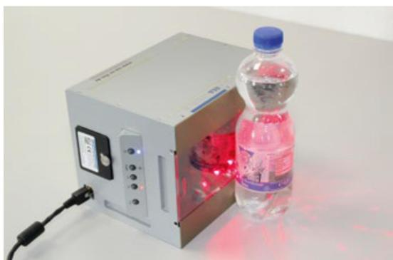
Die ermittelten Messwerte werden über die Netzwerkschnittstelle und ein Standard-Netzwerkkabel zur Auswertung und Verarbeitung an einen PC mit der REA TransWin32 Auswertungs-Software übertragen.
